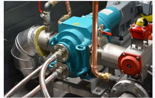
Bomba BLUEline con camisa y tapa calentamiento
