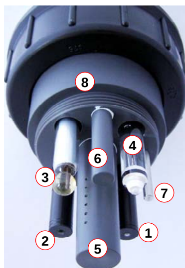
Fig. 4-2: Anordnung der Elektroden und Elektrodenkopf ohne Schutzkappen und ohne Schutzkorb (links) sowie gesamter ammo::lyser (rechts)
