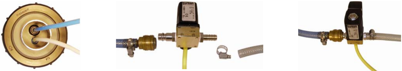
Fig. 6-2: Anschluss Sondenreinigung an ammo::lyser (links) und Anschluss an Reinigungsventil (Mitte und rechts) Connection cleaning appliance to ammo::lyser (left) and connection to cleaning valve (middle and right)
